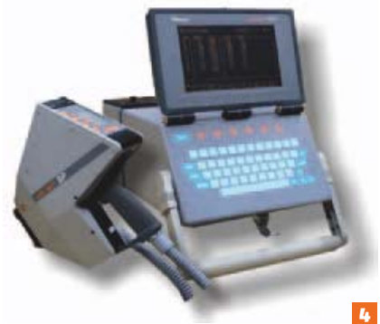
1 Videoendoskope für den Industriebereich ermöglichen die Überprüfung fertiger Bauteile auch an unzugänglichen Stellen 2 Auch bei der Brückeninspektion ist auf die mobile Videoendoskopie Verlass 3 Der große Vorteil der Röntgenfluoreszenzanalyse liegt in der völlig zerstörungsfreien Prüfmethode „Werkstoffanalyse mittels Röntgenstrahlung“ 4 Die Optische Emissionsspektrometrie ist eine weitere Methode, die chemische Zusammensetzung eines Materials bestimmen zu können
